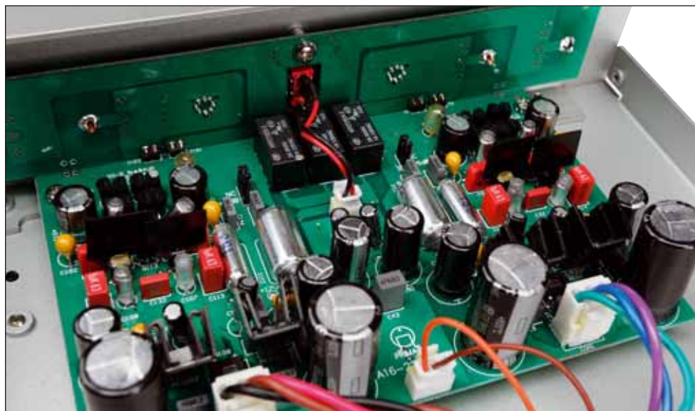
Die wertig bestückte Platine in Doppel-Mono-Aufbau kauert hinter der Frontplatte des Primare
